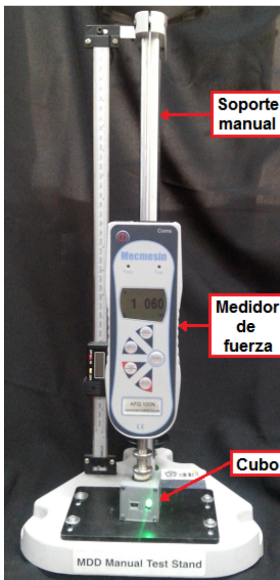
Figura 4.4: Medidor de Fuerza Digital AFG acoplado a un Soporte Manual de Ensayo.
